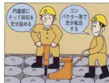
4. 間詰砕石の充填・締固め
