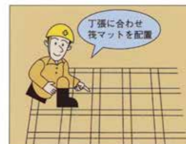
2. 筏マットの敷設
