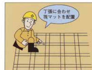
2. 筏マットの敷設
