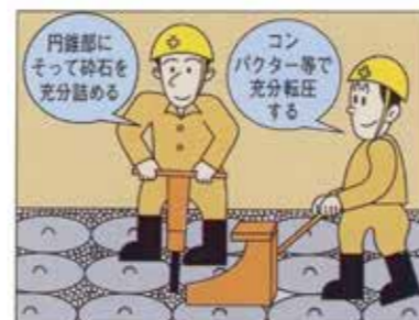
4. 間詰砕石の充填・締固め
