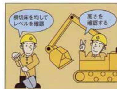
1. 敷設面のチェック
